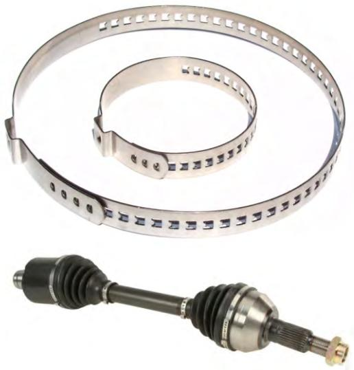
Variabel einstellbare Lochbandschelle für die Montage von Achsmanschetten an den Gelenken und Antriebswellen. Ideal für die Befestigung der Gummimanschette direkt auf der Gelenkwelle. gefertigt aus rostfreiem Edelstahl. einfache Handhabung durch Einhaken in der kürzest möglichen Position und anschließendem Spannen mit einer einfachen Kneifzange (analog zu den 1-Ohr-Schlauchschellen).
