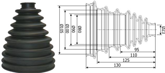
Universell einsetzbarer Faltenbalg für die gängigsten europäischen und asiatischen Geländefahrzeuge. Hergestellt aus hochflexibler, spezieller Neopren-Naturkautschukmischung, resistent gegen alle chemischen und atmosphärischen Einflüssen, somit haltbar über viele Jahre.
