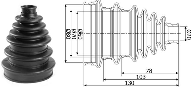
Universell einsetzbarer Faltenbalg im PKW-Bereich. Hergestellt aus hochflexibler, spezieller Neopren-Naturkautschukmischung, resistent gegen alle chemischen und atmosphärischen Einflüssen, somit haltbar über viele Jahre.
