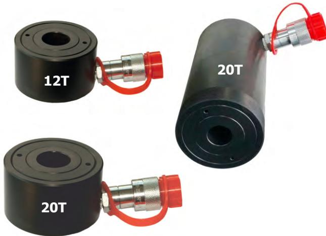
Hydraulik-Hohlkolbenzylinder in niedriger Bauhöhe, mit hoher Hublast, mit durchgehendem Hohlkolben zur Aufnahme von Druckspindeln. Geeignet für Druck- u. Zugarbeiten und ausgestattet mit starker Rückzugfeder. Oberfläche gasnitriert und schwarz passiviert für besten Rostschutz.
