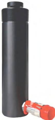
Mehrzweck-Hydraulikzylinder einfachwirkend mit Außengewinde M68x2 am Zylinderkopf, Kolbenstangeninnengewinde M27x3 sowie Hängeöse am Zylinderboden. Ausgestattet mit leistungsstarker Rückzugfeder. Oberfläche gasnitriert und schwarz passiviert für besten Rostschutz. Der Zylinder wird mit Druckpilz, Gewindeschutzkappe und 3/8"-NPT Hydraulik-Kupplung geliefert.
